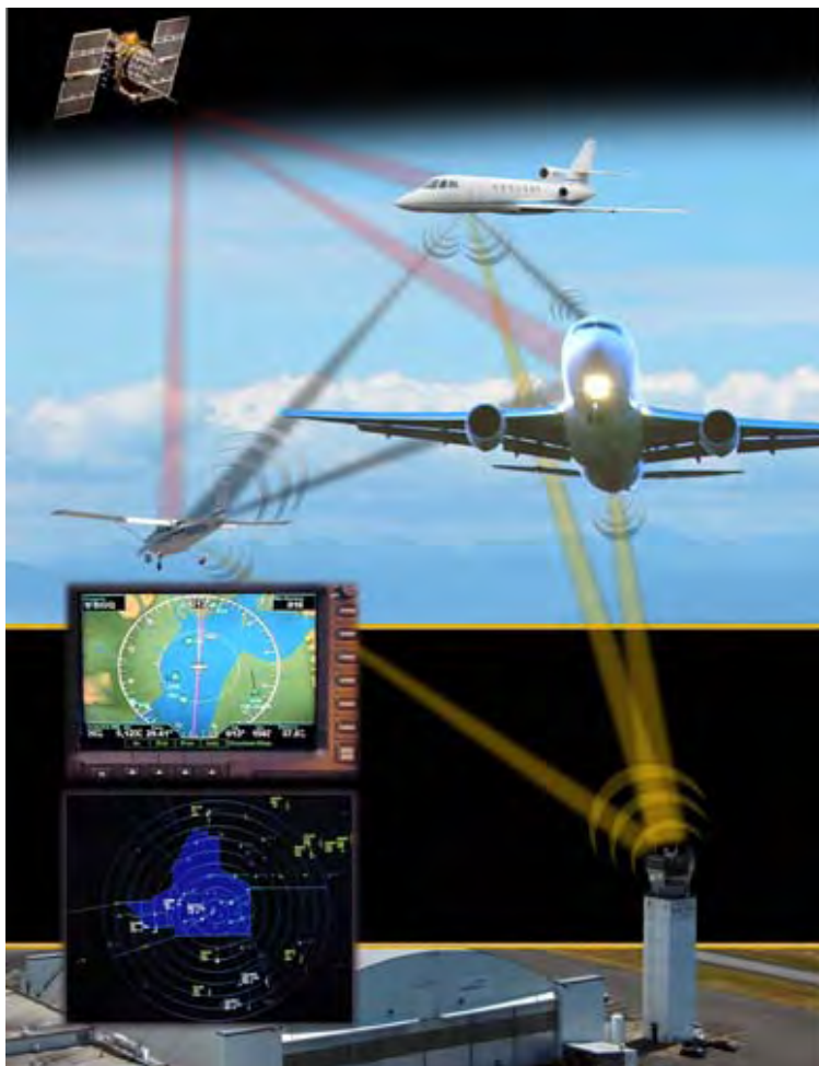
Principe du système ADS-B
