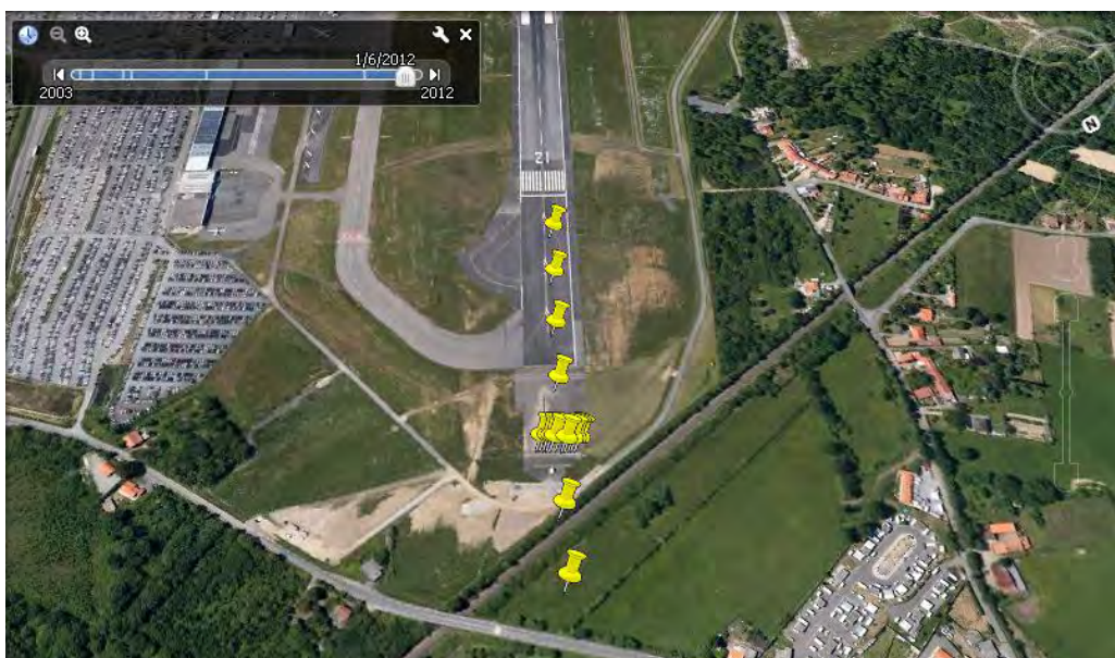
Tracé de la rampe lumineuse QFU 21.
