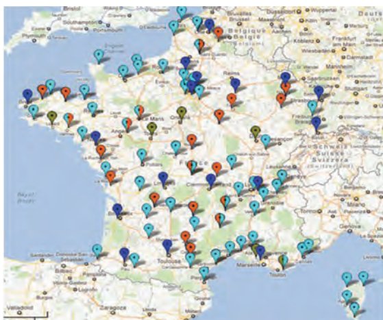
Présence d'ILS CAT I et CAT III (en bleu clair et foncé) et GNSS (en jaune) Cartes de la situation aujourd'hui (à gauche) et demain (à droite).
