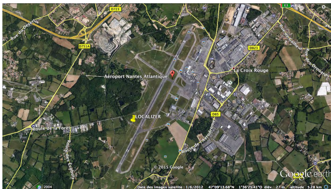
Emplacement possible du Localizer ILS CAT i Offset QFU21.
