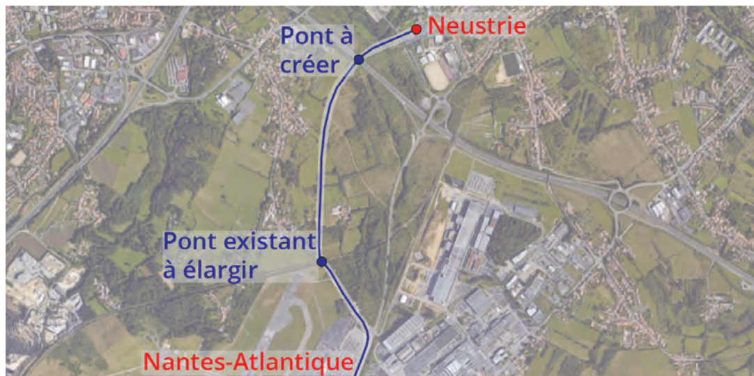
Tracé possible du prolongement de la ligne de tramway et aménagements à prévoir, solution 1.
